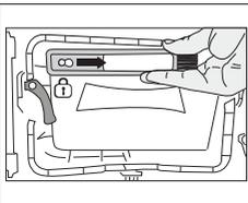
Ziehen Sie nach dem Reinigen des Filters, der Tür und des Kondensators die Bürste nach rechts und platzieren Sie sie in der Halterung.
