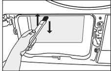
**i** Sie können von Hand reinigen, sofern Sie Schutzhandschuhe tragen. Versuchen Sie nicht, mit bloßen Händen zu reinigen. Die Kondensatorlamellen können Ihre Hände verletzen. Die Reinigung von links nach rechts kann die Kondensatorlamellen beschädigen. Dies kann zu Trocknungsproblemen führen.
