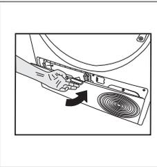
Setzen Sie nach Abschluss des Reinigungsvorgangs die Luftleitblechabdeckung an ihren Platz, bewegen Sie die Riegel, um sie zu schließen, und schließen Sie das Bordbrett.
