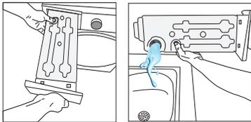
Wenn sich Fusseln im Trichter des Wassertanks ansammeln, entfernen Sie diese unter fließendem Wasser.
