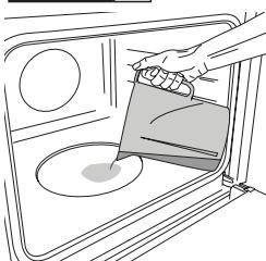
Tek kada je pećnica hladna, napunite udubljenje u pećnici količinom vode navedenom u odgovarajućoj tablici pečenja. Namirnice stavite u pećnicu. Postavite i uključite funkciju **STEAM**: Na kraju pažljivo otvorite vrata i pustite da para polako izađe.
