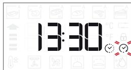
Bei Bedarf den *Einstellknopf* drehen, um das gewünschte Garzeitende einzustellen, anschließend mit
