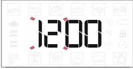
Die beiden Ziffern für die Stunden beginnen zu blinken: Den Knopf drehen, um die Stunden einzustellen und **OK** zur Bestätigung drücken.
