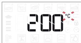
Wenn die Symbole °C/°F auf dem Display blinken, den *-Knopf* drehen, um den Wert zu ändern, anschließend
