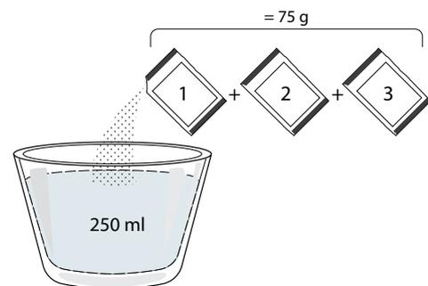
Pēc atkaļķošanas šķīduma iepildes atvilktnē nospiediet
