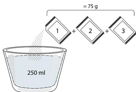
Kada sipate rastvor za uklanjanje kamenca u fioku, pritisnite
