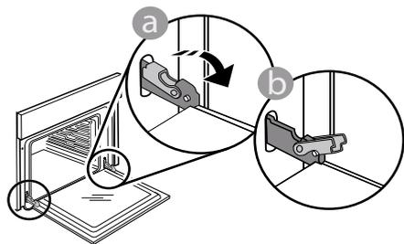
**2.** Zatvorite vrata koliko god je moguće. Čvrsto držite vrata sa obe ruke – ne držite ih za dršku. Jednostavno skinite vrata tako što ćete nastaviti da ih zatvarate dok ih istovremeno povlačite nagore i oslobađate iz njihovog ležišta. Položite vrata da leže na jednoj strani, na mekanoj površini.
