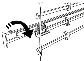
Z trouby odstraňte boční vodicí mřížky a z posuvných drážek ochranné fólie. Připevněte horní sponu drážky k vodicí mřížce a suňte ji po celé délce až na doraz. Druhou sponu posuňte směrem dolů, dokud nedosáhne správné polohy.
