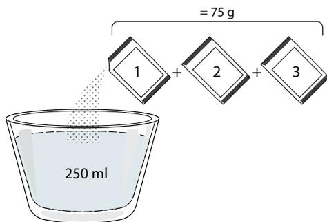
Kada otopinu za uklanjanja kamenca ulijete u ladicu, pritisnite
