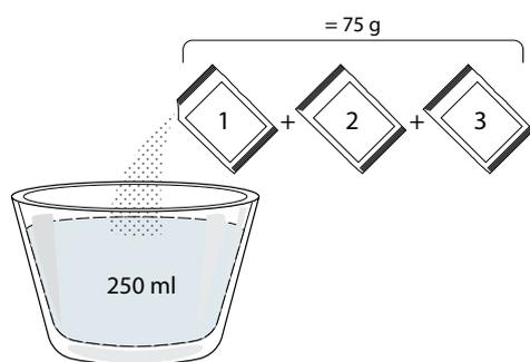
Ko raztopino za odstranjevanje vodnega kamna vlijete v predal, začnite glavni postopek odstranjevanja vodnega kamna s pritiskom na . Med posameznimi koraki odstranjevanja vodnega kamna vaša prisotnost ob aparatu ni potrebna. Po vsakem končanem koraku se oglasi zvočni signal, na zaslonu pa se prikažejo navodila za prehod na naslednji korak.
