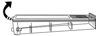
1. Nyomja felfelé a hátsó szárnyat a vízbetöltő fiók felső fedelének eltávolításához.
