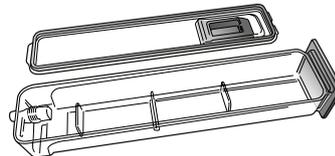
2. Po skončení čištění můžete zásuvku zavřít zasunutím dvou předních klapek do předních otvorů a zatlačením zadní strany dolů.
