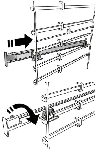
Vyberte vodiace lišty z rúry a z posuvných bežcov odstráňte ochranné plasty. Pripevnite vrchnú svorku bežca na vodiacu lištu a nasuňte, pokiaľ to ide. Druhú svorku spustite na miesto.
