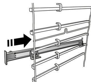
Uklonite vodilice rešetki iz pećnice i uklonite zaštitnu plastiku s kliznih vodilica. Pričvrstite gornju kopču vodilice na vodilicu rešetke i do kraja je klizno pomaknite. Donju kopču spustite u položaj.
