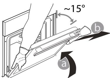
**3.** Įstatydami dureles pastumkite jas link orkaitės, sulygiuokite vyrių kabliukus tvirtinimo vietose ir užfiksuodami viršutinę dalį.
