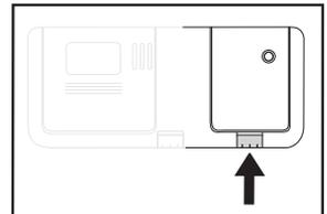
Remplissez le doseur de liquide de rinçage jusqu'au repère **MAX** (~150 ml).
