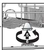
Insérez et serrez à fond les bras d'aspersion supérieur et inférieur.
