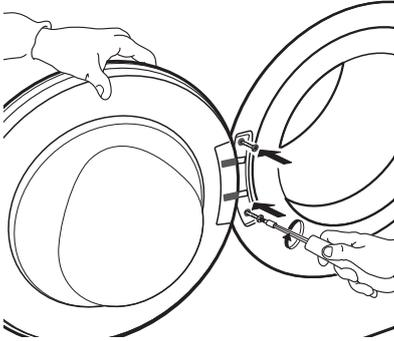
**6.** Die Türverriegelung auf der rechten Seite der Türöffnung anbringen. Vollständig in das Loch drücken und dann etwas nach unten schieben, bis der kleine Knopf der Türverriegelung einrastet.
