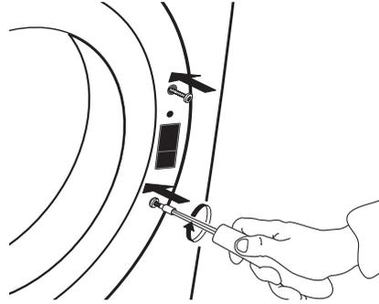
**8.** Den Kontaktstift innen auf dem oberen Teil der Tür einsetzen. Drehen Sie den Kontaktstift mit Zangen um 90° nach rechts um ihn zu sperren.
