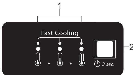
1. Led lampe indikatora (za prikaz postavljene vrednosti temperature ili funkcije za brzo hlađenje)
