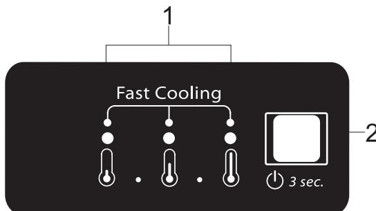
1. LED jelzőfények (az aktuális hőmérsékleti érték vagy a Gyorshűtés funkció jelzése)
