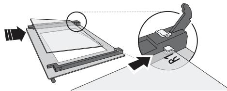
4. Replacez le bord supérieur : un déclic indique qu'il est bien placé. Assurez-vous que le joint est bien placé avant de remonter la porte.
