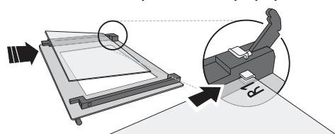
4. Επανατοποθετήστε την άνω γωνία: Ένα κλικ δείχνει ότι τοποθετήθηκε σωστά. Βεβαιωθείτε ότι η τσιμούχα είναι καλά σταθεροποιημένη πριν επανατοποθετήσετε την πόρτα.
