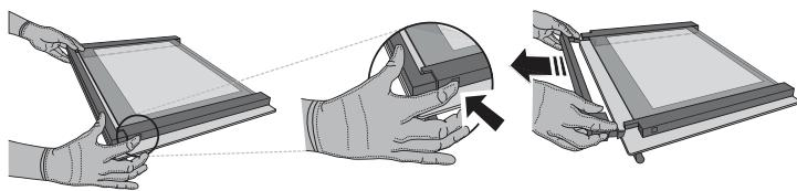
2. Hef en hou de binnenuit stevig vast met beide handen, verwijder het en leg het op een zacht oppervlak vooraleer het te reinigen.
