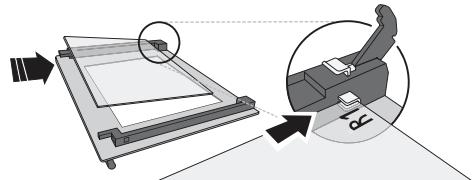
4. Montați la loc marginea superioară: Poziționarea corectă se realizează după ce se aude un clic. Asigurați-vă că garnitura este fixată sigur înainte de a remonta ușa.
