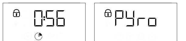
Wenn das Programm fertig ist, bleibt die Tür gesperrt, bis die Temperatur im Gerät auf ein sicheres Niveau gesunken ist. Den Raum während und nach dem Pyrolysezyklus lüften.
