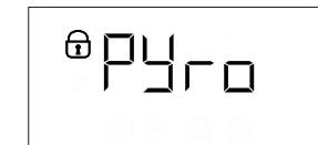
Odată cu finalizarea ciclului, ușa rămâne blocată până când temperatura din interiorul cuptorului revine la o valoare de siguranță. Aerisiți încăperea în timpul și la finalizarea derulării ciclului Pyro.
