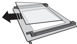
3. Herplaats het middenpaneel (gemarkeerd met "1R") voordat u het binnenpaneel terugplaast: Om de ruiten correct terug te plaatsen, zorg ervoor dat het merk "R" zichtbaar is in de linkerhoek. Breng eerst de lange zijde van de ruit met het merk "R" in de zittingen, en breng de ruit omlaag tot die op zijn plek komt. Herhaal deze procedure voor beide glasruit.
