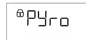
Після завершення циклу дверцята залишаються заблокованими, поки температура всередині духової шафи не повернеться до безпекного рівня. Провітрійте приміщення протягом циклу піролізного чищення та після його завершення.
