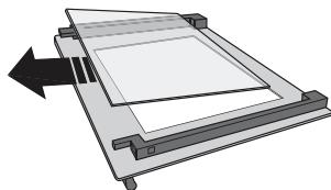
3. Встановіть проміжну панель (позначену «1R») перед встановленням внутрішньої панелі: Щоб правильно встановити скляні панелі, переконайтесь, що в лівому кутку видно позначку R. Спочатку вставте довгу сторону скла, позначену літерою R, в опорні гнізда, а потім опустіть його на місце. Повторіть цю процедуру для обох скляних панелей.
