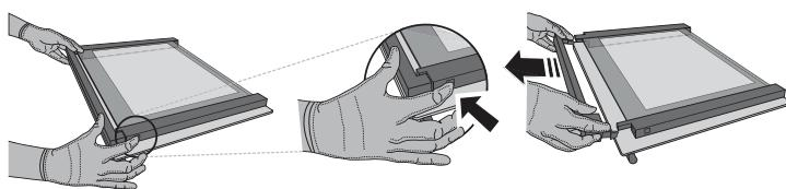
2. Z obema rokama dvignite in čvrsto držite notranje steklo, ga odstranite in položite na mehko površino, preden ga očistite.
