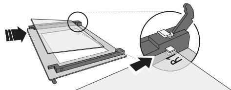
4. Die obere Kante wieder anbringen: ein Klick bestätigt die richtige Positionierung. Sicherstellen, dass die Dichtung vor Wiedereinbau der Tür befestigt wird.
