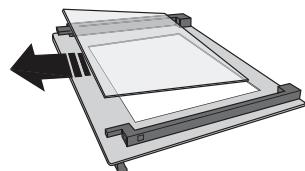
3. Montați la loc panoul intermediar (marcat cu „1R”) înainte de a remonta panoul interior: Pentru a poziționa corect panourile de sticlă, asigurați-vă că marcajul „R” poate fi observat în colțul din partea stângă. Mai întâi, introduceți latura lungă a geamului marcată cu litera „R” în locașurile de susținere, apoi coborâți-o în poziție. Repetați această procedură pentru ambele panouri de sticlă.
