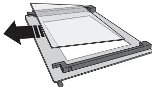
3. Paigaldage tagasi vaheplaat (tähistusega „1R“) enne siseplaadi paigaldamist: Klaastahvlite õige asetuse jaoks veenduge, et tähis “R” jäääb vasakusse nurka. Kõigepealt pange klaasi pikk külg (märgitud R-tähega) tugeemale, seejärel langetage see paika. Korake sama mõlema klaastahvliga.
