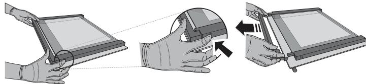
2. Σηκώστε και κρατήστε σταθερά το εσωτερικό τζάμι και με τα δύο χέρια, αφαιρέστε το και τοποθετήστε το σε μια μαλακή επιφάνεια πριν το καθαρίσετε.
