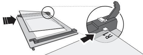
4. Namontujte horní lištu: Zavaknutí indikuje správnou montáž. Před nasazením dvířek zkонтrolujte těsnění.
