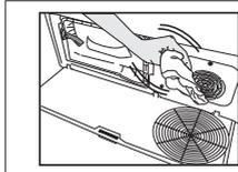
Qualora venga visto un accumulo di fibre sul coprивentola e sulla tavola di fondo, si prega di rimuoverlo con un panno.
