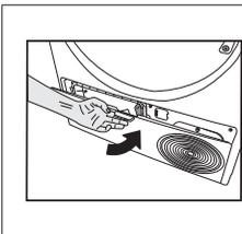
Dopo aver completato il processo di pulizia, rimettere il coperchio del deflettore dell'aria in posizione, spostare i fermi per chiuderlo e chiudere lo zoccolo base.
