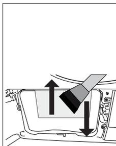
Pulire la fibra sulla superficie metallica del condensatore con un panno umido o la spazzola sul deflettore dell'aria in direzione su - giù. Non pulire con la direzione destra-sinistra perché danneggia le piastre metalliche del condensatore. Sarà possibile usare un aspirapolvere con una spazzola per la pulizia. Se l'aspirapolvere non dispone di una spazzola, sconsigliamo di usarlo per la pulizia del condensatore.
