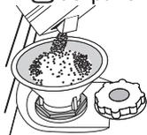
1. Retire la bandeja inferior y desenrosque el tapón del depósito (en sentido antihorario).
