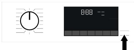
Se il livello dell'acqua nella macchina non è adeguato, premendo il pulsante Avvio/Pausa, il blocco dello sportello non potrà essere disattivato e il simbolo del blocco sportello resterà acceso sul display.
