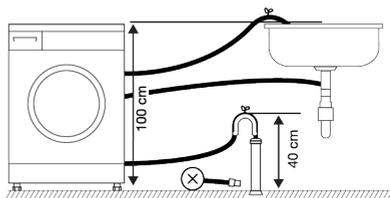
4. Per evitare che l'acqua di scarico torni di nuovo nella lavatrice e per garantire un facile drenaggio, non immergere l'estremità del tubo nell'acqua di scarico o non inserirlo nello scarico per più di 15 cm. Se è troppo lungo, accorciarlo.
