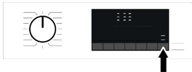
Quando la funzione di Controllo Remoto è attiva, tramite la lavatrice è possibile gestire solo le operazioni di spegnimento e di monitoraggio dello stato. Tutte le funzioni eccetto il blocco bambini possono essere gestite tramite l'applicazione.
