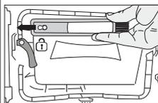
Tirare la spazzola verso sinistra per toglierla. Sarà possibile usare la spazzola di pulizia per pulire il filtro, la superficie metallica di condensazione e le fibre accumulate sulla porta.
