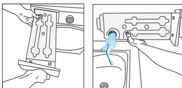
Se si accumula lanugine nell'imbutto del serbatoio dell'acqua, rimuoverle sotto l'acqua corrente.
