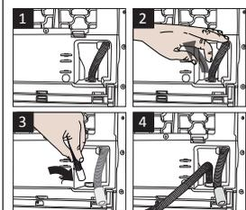
1-2 Rimuovere il tubo flessibile dietro l'asciugatrice tirandolo manualmente da dove è attaccato. Non usare un attrezzo per rimuovere il tubo.
