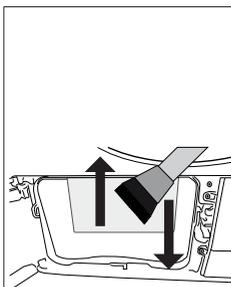
Pulire la fibra sulla superficie metallica del condensatore con un panno umido o la spazzola sul deflettore dell'aria in direzione su - giù. Non pulire con la direzione destra-sinistra perché danneggia le piastre metalliche del condensatore.
