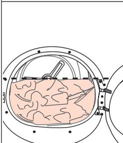
Se il bucato all'interno della macchina supera la capacità di carico massima, potrebbe non funzionare come previsto e potrebbe causare danni materiali o danneggiare il prodotto. Per ogni programma, attenersi alla capacità massima di carico.
