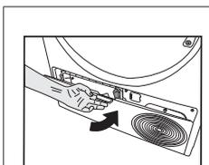
Dopo aver completato il processo di pulizia, rimettere il coperchio del deflettore dell'aria in posizione, spostare i fermi per chiuderlo e chiudere lo zoccolo base.
