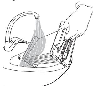
Reinigen Sie die Filterkammer des Trockners vorsichtig mit einem feuchten Tuch oder mit einem Staubsauger. Bodenfilter wieder einsetzen. Die Riegel nach oben in eine senkrechte Position drehen. Die Bodenklappe schließen.
