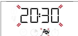
Gebruik + of — om de tijd in te stellen waarop u de bereiding wilt beëindigen en druk op ☰ om te bevestigen. Activeer de functie door de *thermostaatknop* naar de gewenste temperatuur te draaien: de functie blijft in pauze en start automatisch na een periode die berekend is om de bereiding te laten eindigen op het door u gekozen tijdstip.
