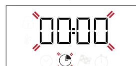
oder + zum — Einstellen der gewünschten Garzeit verwenden, anschließend zur Bestätigung ⏱ drücken. Die Funktion durch Drehen des *Thermostatreglers* auf die gewünschte Temperatur aktivieren: Es ertönt ein akustisches Signal und das Display zeigt an, dass der Garvorgang beendet ist.
