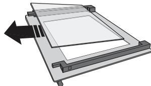
3. Bringen Sie die Zwischenscheibe wieder an (gekennzeichnet mit „1R“) bevor Sie die Innenscheibe wieder einbauen: Um das Glasscheiben richtig einzusetzen, sicherstellen, dass das Zeichen „R“ in der linken Ecke sichtbar ist. Zuerst die lange Seite des Glas, die mit einem „R“ gekennzeichnet ist in die Halterungen einsetzen, dann in die Position absenken. Wiederholen Sie diesen Vorgang bei beiden Glasscheiben.
