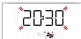
Utilizzare o per impostare l'ora in cui desidera terminare la cottura e premere per confermare. Attivare la funzione ruotando la *manopola del termostato* sulla temperatura desiderata: la funzione resterà in pausa fino ad avviarsi automaticamente dopo un periodo di tempo calcolato per terminare la cottura all'orario impostato.
