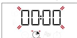
Utilisez + ou - pour régler le temps de cuisson dont vous avez besoin, puis appuyez sur ☰ pour confirmer. Activez la fonction en tournant le *bouton du thermostat* à la température désirée : un signal sonore et l'écran indiquent la fin de la cuisson.
