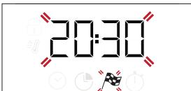
+ oder — zum Einstellen der Abschaltzeit verwenden und ⏱ zur Bestätigung drücken. Die Funktion durch Drehen des *Thermostatreglers* auf die gewünschte Temperatur aktivieren: Die Funktion ist angehalten, bis sie automatisch nach der berechneten Zeit startet, damit der Garvorgang zur eingestellten Zeit endet.
