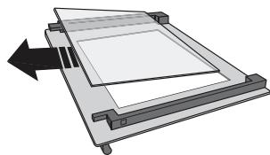
3. Réinstaller le panneau intermédiaire (marqué d'un "1R") Avant de remonter le panneau intérieur : Pour placer correctement les parois de verre, assurez-vous que la marque « R » se trouve dans le coin gauche. En premier, insérez la longue partie de la vitre marquée d'un « R » dans les appuis des guides, abaissez-la ensuite en place. Répétez cette procédure pour les deux parois de verre.
