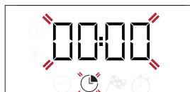
Utilizzare o per impostare la durata desiderata, quindi premere per confermare. Avviare la funzione ruotando la *manopola termostato* in corrispondenza della temperatura desiderata: un segnale acustico e il display avviseranno del termine della cottura.
