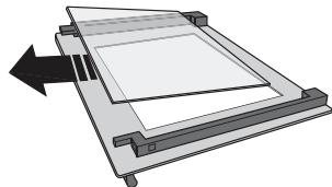
3. Herplaats het middenpaneel (gemarkerd met "1R") voordat u het binnenpaneel terugplaatst: Om de ruiten correct terug te plaatsen, zorg ervoor dat het merk "R" zichtbaar is in de linkerhoek. Breng eerst de lange zijde van de ruit met het merk "R" in de zittingen, en breng de ruit omlaag tot die op zijn plek komt. Herhaal deze procedure voor beide glasruit.
