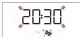
Utilisez + ou — pour régler l'heure de fin de cuisson et appuyez sur ☰ pour confirmer. Activez la fonction en tournant le *bouton du thermostat* à la température souhaitée : la fonction reste en veille et démarre automatiquement après la période d'attente calculée pour que la cuisson se termine à l'heure désirée.
