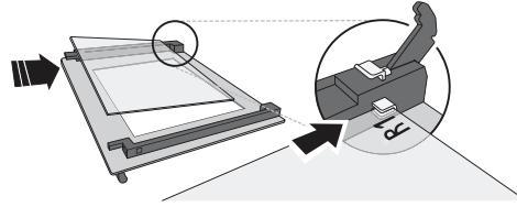
4. Rimontare il profilo superiore: un clic indica il corretto posizionamento. Verificare che la tenuta sia salda prima di rimontare la porta.
