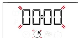
Gebruik + of - om de gewenste bereidingstijd in te stellen en druk dan op ☰ om te bevestigen. Activeer de functie door de *thermostaatknop* te draaien op de gewenste temperatuur: er klinkt een geluidssignaal en op de display wordt aangegeven dat de bereiding klaar is.
