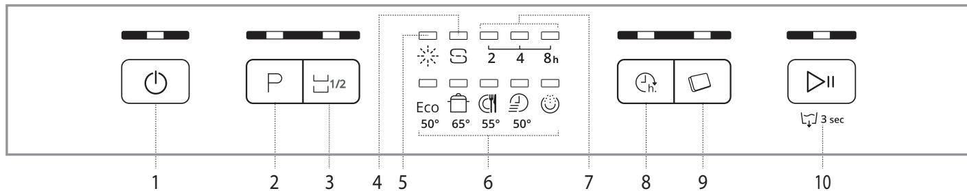
1. Gumb za uklj/isklj/ponovno postavljanje sa svjetlom indikatora
