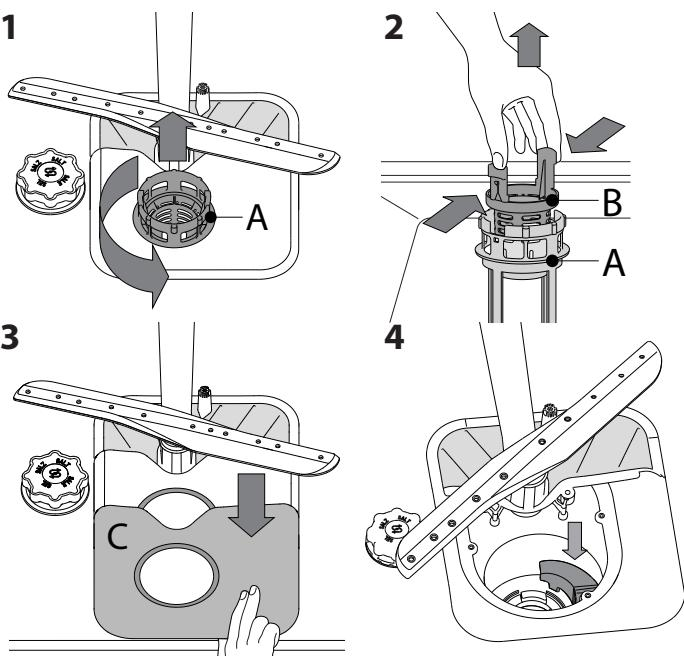
Nakon čišćenje filtra vratite sklop filtra i pravilno ga učvrstite na mjesto; to je važno za održavanje učinkovitog rada perilice suđa..
