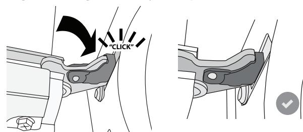
5. Probeer de deur te sluiten en controleer of het in lijn met het bedieningspaneel is. Als dit niet het geval is herhaalt u de bovenstaande stappen: Als het niet goed werkt kan de deur beschadigd raken.
