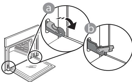
Verwijder de deur door deze te blijven sluiten en tegelijkertijd omhoog te trekken totdat het loshaakt. Zet de deur opzij en laat deze op een zachte ondergrond rusten.
