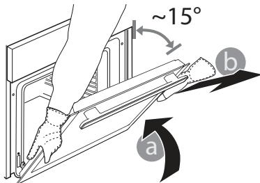
**3.** Per rimontare la porta, avvicinarla al forno allineando i ganci delle cerniere alle proprie sedi e ancorare la parte superiore agli alloggiamenti.
