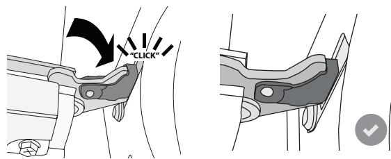
**5.** Provare a chiudere la porta, verificando che sia allineata al pannello di controllo. Nel caso non lo fosse, ripetere i passi sopra descritti: La porta potrebbe danneggiarsi se non funziona correttamente.
