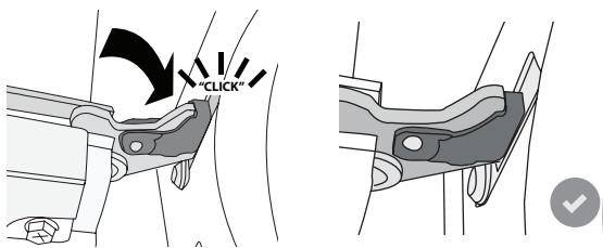
**5.** Proovige ust sulgeda ja vaadake, et see oleks juhtpaneeliga ühel joonel. Kui pole, korraage ülalkirjeldatud toiminguid: Kui uks ei liigu korralikult, võib see viga saada.
