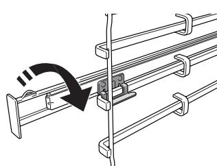
Išimkite lentynų laikiklius iš orkaitės ir nuimkite apsaugines plastikines dalis nuo slankiojančių grotelių. Viršutinį grotelių fiksatorių pritvirtinkite prie skersinių grotelių ir nustumkite jį iki galio. Į tą padėtį nuleiskite ir kitą fiksatorių.
