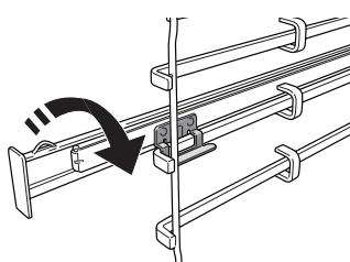
Aby byla vodicí mřížka dobře zajištěna, zatlačte pevně spodní část spony oproti vodicí mřížce. Ujistěte se, že drážkami lze volně pohybovat. Postupujte stejně i na druhé straně vodicí mřížky v rámci stejné výškové úrovně.
