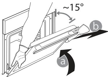
**3.** Įstatydamis dureles pastumkite jas link orkaitės, sulygiuokite vyrių kabliukus tvirtinimo vietose ir užfiksiodami viršutinę dalį.
