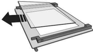
3. Prima di rimontare il vetro interno è necessario riapplicare il vetro intermedio (contrassegnato con "1R"): Per posizionare correttamente i vetri, verificare che la marcatura "R" sia visibile nell'angolo sinistro. Inserire dapprima il lato lungo del vetro contrassegnato con "R" nelle sedi di sostegno, quindi abbassarlo in posizione. Ripetere la procedura per entrambi i vetri.
