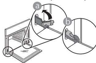
4. Abbassare la porta e poi aprirla completamente. Abbassare i fermi nella posizione originale: fare attenzione che siano completamente abbassati.
