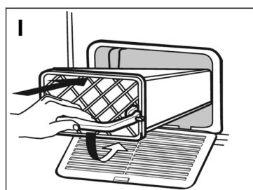
I. Vratite filter u sušilicu, s ručkom u vodoravnom položaju. Kada se filter potpuno umeđnut, pomaknite ručku prema dolje kako biste pričvrstili filter u mjestu. Provjerite je li ručka potpuno zakvačena s obje strane iza kvačica područja kućišta.
