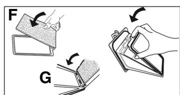
G. Postavite okvir filtera u kućište tako da umeđnete jezike okvira u utore na kućištu filtera i zatim pritisnute bravicu u mjestu. Pazite da se pjena ne uklješti između dijelova filtera.
