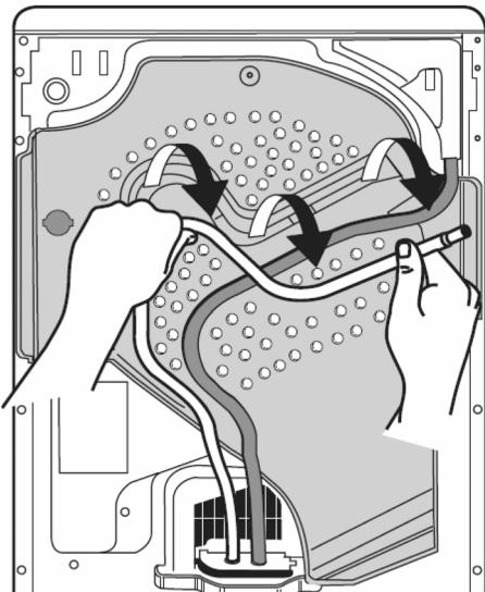
C. Spojite crijevo na kanalizacijski sustav. Razlika u visini između poda na kojem se nalazi sušilica i spoja na kanalizacijski sustav ne smije biti veća od 1 m.
