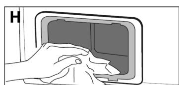
H. Rukom, vlažnom krpom ili vrlo pažljivo usisavačem, očistite kućište filtera i mrežicu u unutrašnjosti.
