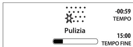
A ciclo ultimato, il relativo messaggio di avviso lampeggia sul display. La temperatura residua viene indicata sul display mentre la porta rimane bloccata fino a quando non viene raggiunta una temperatura sicura. A quel punto, sul display compare l'ora corrente.
