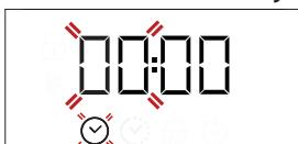
Pomocou + alebo - nastavte hodinu a stlačte na potvrdenie. Začnú blikáť číslice označujúce minúty. Pomocou + alebo - nastavte minúty a stlačte na potvrdenie.
