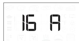
Obrócić pokrętło wyboru, aby wybrać prąd znamionowy, a następnie naciąć , aby zatwierdzić.
