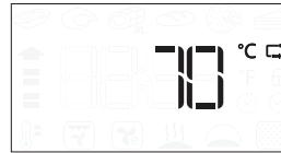
Ukoliko je sonda za meso prikačena prilikom biranja funkcije, displej će se prebaciti na uobičajenu temperaturu koju meri sonda za meso. Pritisnite da biste započeli postavke. Okrenite dugme da biste podesili željenu temperaturu sonde za meso. Pritisnite da biste potvrdili. Okrenite dugme da biste podesili temperaturu
