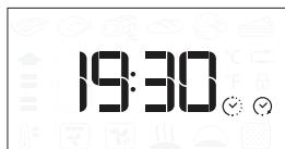
Obratite pažnju na sledeće: Programiranje odloženog početka kuvanja onemogućuje fazu predzagrevanja rerne. Rerna postepeno dostiže željenu temperaturu, što znači da je vreme kuvanja nešto duže od onog koje je navedeno na tabeli kuvanja.
