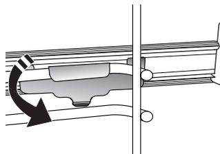
Per fissare la guida, premere la parte inferiore della clip contro la griglia laterale. Assicurarsi che le guide possano scorrere liberamente. Ripetere questa operazione sull'altra griglia laterale, allo stesso livello.
