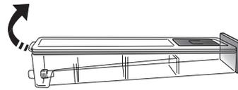
1. Drücken Sie die hintere Klappe nach oben, um die obere Abdeckung des Wassereinfüllfachs zu entfernen.
