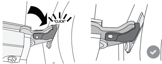
**5.** Provare a chiudere la porta, verificando che sia allineata al pannello di controllo. Nel caso non lo fosse, ripetere i passi sopra descritti: La porta potrebbe danneggiarsi se non funziona correttamente.
