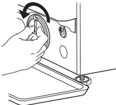
4. Odstráňte filter: Pod filter položte bavlnenú handru, ktorá absorbuje malé množstvo zostávajúcej vody. Odstráňte filter otáčaním proti smeru hodinových ručičiek.
