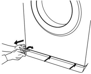
2. Nádoba na vypustenú vodu: Umiestnite pod vodný filter nízku a širokú nádobu na zachytenie zvyšnej vody.
