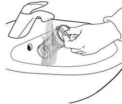
6. Vložte vodný filter a nasadte späť sokel: Vložte filter späť na svoje miesto krútením v smere hodinových ručičiek. Zapojte ho čo najrýchlejšie; držadlo filtra musí byť v zvislej polohe. Vodotesnosť filtra vyskúšate tak, že do dávkovača pracieho prostriedku nalejete asi 1 liter vody. Potom nasadte späť sokel.
