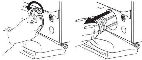
5. Vyčistite filter: odstráňte zvyšky z filtra a očistite ho pod tečúcou vodou.
