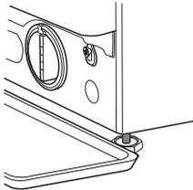
3. Vypustite vodu: Pomaly otáčajte filter proti smeru hodinových ručičiek, kým nevytečie všetka voda. Nechajte vodu vytekať, ale filter neodstraňujte. Keď sa nádoba naplní, zatvorte filter otáčaním v smere hodinových ručičiek. Vyprázdnite nádobu. Opakujte tento postup, až kým nevytečie všetka voda.
