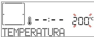
Quando il valore lampeggia sul display, ruotare la **manopola di regolazione** per modificarlo, quindi premere  $\checkmark$  per confermare e continuare a modificare le impostazioni che seguono (se possibile).
