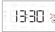
Vajadusel keerake nuppu, et määrata küpsetamise lõpuaeg, ning seejärel vajutage kinnitamiseks ja funktsiooni käivitamiseks .
