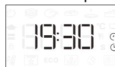
Note: La programmazione dell'avvio ritardato di una cottura disattiva la fase di preriscaldamento del forno: la temperatura desiderata viene raggiunta gradualmente, quindi i tempi di cottura si allungheranno leggermente rispetto a quanto indicato nella tabella di cottura.
