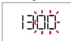
De twee cijfers voor de minuten beginnen te knipperen. Draai aan de knop om de minuten in te stellen en druk op om te bevestigen.
