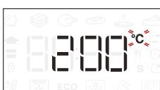
Když ikona bliká na displeji, otočte knoflíkem pro změnu hodnoty a poté pro potvrzení stiskněte a pokračujte v přizpůsobování nastavení, které následuje (je-li to možné).
