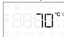
Stlačením ⓘ spustite nastavenia. Otáčaním gombíka nastavte cielovú teplotu mäsovej sondy. Stlačením ⓘ potvrďte.
