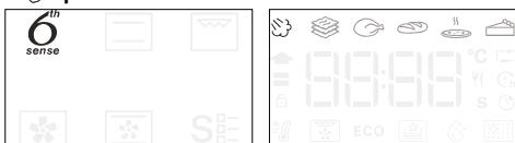
Gire el selector rotativo para seleccionar una de las subfunciones disponibles en la parte derecha de la pantalla y después pulse
