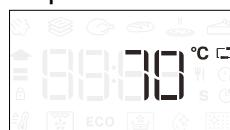
Nyomja meg a gombot a beállításokhoz. Forgassa el a beállítógombot a hússzonda célhőmérsékletének beállításához. Nyomja meg a gombot a megerősítéshez.
