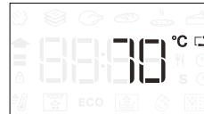
Vajutage seadete avamiseks nuppu ☺. Pöörake nuppu, et seada lihatermomeetri sihltterminatuur. Kinnitamiseks vajutage nuppu ☺.
