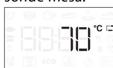
Pritisnite ☺, da začnete z nastavljanjem. Obrnite gumb, da nastavite želeno temperaturo sonde za meso. Pritisnite ☺ za potrditev.
