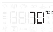
Appuyez sur pour démarrer les réglages. Tournez le bouton pour régler la température cible de la sonde de cuisson. Appuyez sur pour confirmer.
