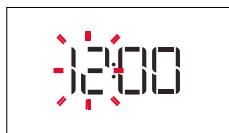
Les deux chiffres de l'heure clignotent : Tourner le bouton pour régler l'heure et appuyer sur
