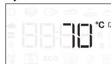
Stiskem spusťte nastavení. Otáčením ovladače nastavte cílovou teplotu sondy. K potvrzení stiskněte .
