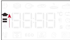
Після завершення фази пролунає звуковий сигнал, а на дисплей з'явиться сповіщення про те, що духова шафа досягла заданої температури.
