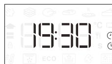
Lūdzu, ņemiet vērā: lestatot aizkavētu gatavošanas sākuma laiku, tiks atspējota cepeškrāsns iepriekšējās uzsildīšanas fāze: krāsns pamazām sasniegls jūsu norādīto temperatūru, kas nozīmē, ka gatavošanas laiks būs ilgāks nekā norādīts gatavošanas tabulā.
