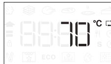
Tryk på for at starte indstillingerne. Drej knappen for at indstille kødtermometerets målt temperatur. Tryk på for at bekræfte.
