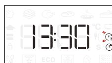
Om nödvändigt, vrid på vredet för att ställa in tiden du vill att tillagningen ska vara klar på och tryck sedan på för att bekräfta och starta funktionen. Sätt in maten i ugnen och stäng luckan: Funktionen startar automatiskt efter den tid som har beräknats för att tillagningen ska vara klar vid inställd tid.
