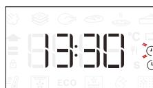
V případě potřeby otáčejte knoflíkem a nastavte požadovaný čas ukončení přípravy. Poté, pro potvrzení volby a spuštění funkce, stiskněte .
