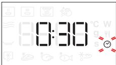
Lorsque l'icône **🕒** clignote à l'écran, utilisez le bouton de réglage pour régler le temps de cuisson désiré, et appuyez ensuite sur **9** pour confirmer ou appuyez sur **▶** pour confirmer et démarrer la fonction.
