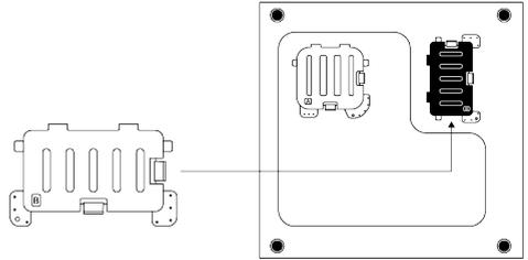
Appoggiare le linguette del coperchio B sul pannello inferiore. Completare il montaggio ruotando il coperchio.
