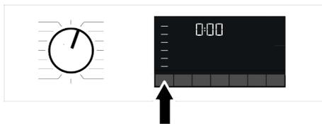
Ogni volta che viene selezionato un nuovo programma, sull'indicatore della temperatura appare la temperatura consigliata. È possibile che la temperatura consigliata non sia il valore massimo selezionabile per il programma corrente.
