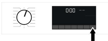
Se il livello dell'acqua nella macchina è insufficiente quando si preme il pulsante Avvio/Pausa, la serratura della porta non può essere disattivata e l'icona della serratura della porta continuerà a comparire sul display.
