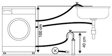
4. Per evitare che l'acqua di scarico torni di nuovo nella lavatrice e per garantire un facile drenaggio, non immergere l'estre-
