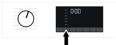
Quando si seleziona un nuovo programma, la velocità di centrifuga consigliata del programma selezionato è visualizzata sull'indicatore velocità di centrifuga. È possibile tale valore consigliato non sia la velocità di centrifuga massima selezionabile per il programma corrente.
