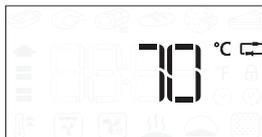
Dersom steketermometeret er koblet til mens det velges en funksjon, bytter displayet til standard ønsket temperatur for steketermometeret.
