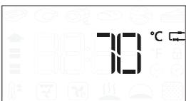
Jos paistomittari kytketään toiminnon valinnan aikana, näyttö vaihtaa oletusasetuksena olevaan paistomittarin haluttuun lämpötilaan.
