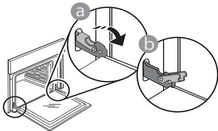
Yksinkertaisesti irrota luukku jatkamalla sen sulkemista ja vetämällä sitä samalla ylöspäin, kunnes se vapautuu paikaltaan. Laita luukku sivuun asettaen se pehmeälle pinnalle.
