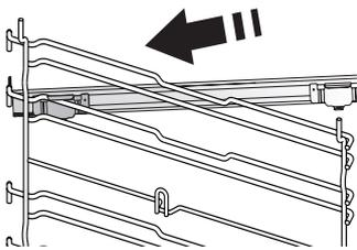
Fäst den rörliga skenans övre klämman på sidostegen och låt den glida så långt som möjligt. Sänk ner den andra klämman på plats.
