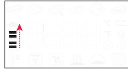
Sobald diese Phase beendet ist, ertönt ein akustisches Signal und das Display zeigt an, dass der Backofen die eingestellte Temperatur erreicht hat.
