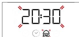
Izmantojiet + vai —, lai iestatītu vēlamo gatavošanas beigu laiku, un nospiediet , lai apstiprinātu. Lai palaistu atlasito funkciju, pagrieziet *termostata slēdzi* uz vēlamo temperatūru: funkcija būs apturēta, taču tiklīdz būs pagājis laiks, kas aprēķināts, lai gatavošana beigtos jūsu noteiktajā laikā, funkcija sāks automātiski darboties.
