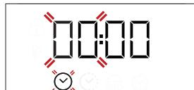
Izmantojiet + vai —, lai iestatītu stundas, un nospiediet ☰, lai apstiprinātu. Displejā mirgos divi cipari, kas apzīmēs minūtes. Izmantojiet + vai —, lai iestatītu minūtes, un nospiediet ☰, lai apstiprinātu.
