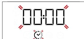
Izmantojiet + vai —, lai atlasītu vēlamo gatavošanas laiku, bet pēc tam nospiediet , lai apstiprinātu. Lai palaistu atlasito funkciju, pagrieziet *termostata slēdzi* uz vēlamo temperatūru: tiklīdz gatavošana būs pabeigta, tiks atskanots skaņas signāls un displejā būs redzams paziņojums.
