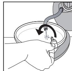
6. Quando o recipiente estiver cheio de água, coloque a tampa na extremidade da mangueira e reintroduza a pequena mangueira na base da máquina de lavar. De seguida, esvazie o recipiente. Em seguida, tape com firmeza a mangueira de drenagem de emergência com a tampa.
