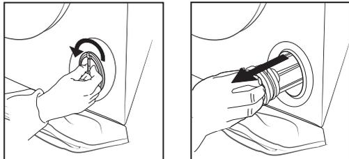
8. Limpe o filtro da bomba de drenagem: remova os resíduos do filtro e lave-o com água corrente.
