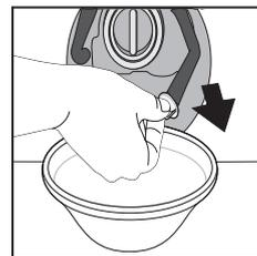
5. Rode a tampa da “mangueira de drenagem de emergência” da extremidade da mangueira e deixe a água sair para dentro do recipiente.
