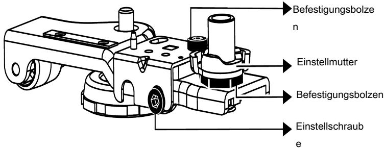
Befestigen Sie die obere Scharnierbaugruppe mit 3 Schrauben.
