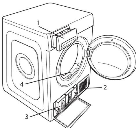
Sicherstellen, dass das Gitter der Belüftungsöffnung frei ist.
