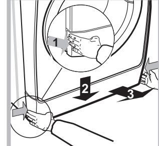
2. проверьте, чтобы уровень воды в машине был ниже отверстия люка. В противном случае слейте излишек воды через сливную трубу в ведро, как показано на схеме.
