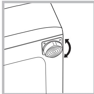
2. После установки машины на место отрегулируйте ее устойчивое положение путем вращения передних ножек (см. рис.). Для этого сначала ослабьте контргайку, после завершения регулировки
