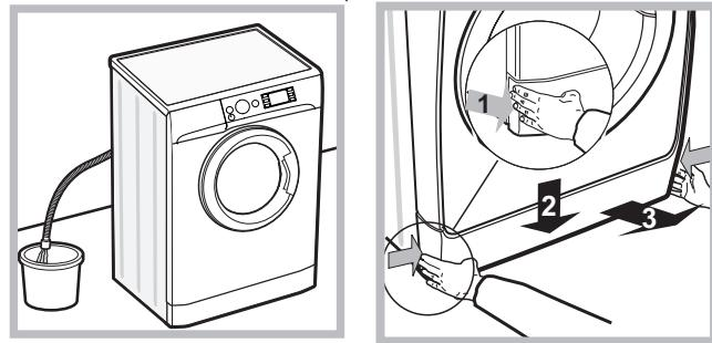
2. s'assurer que le niveau de l'eau à l'intérieur de l'appareil se trouve bien au-dessous de l'ouverture du hublot, si ce n'est pas le cas vider l'eau en excès à travers le tuyau de vidange dans un seau comme illustré voir figure.
