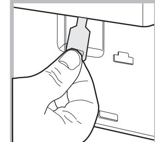
4. потяните наружу язычок, показанный на схеме, вплоть до освобождения пластикового блокировочного винта. Затем потяните его вниз и одновременно откройте люк.
