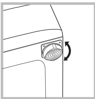
2. Si le sol n'est pas parfaitement horizontal, visser ou dévisser les pieds de réglage avant (*voir figure*) pour niveler l'appareil; son angle d'inclinaison, mesuré sur le plan de travail, ne doit pas dépasser 2°.
