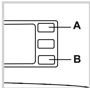
Для запуска программы нажмите одновременно кнопки **A** и **B** на 5 сек. (см. Схему). Программа автоматически запустится и длится примерно 70 минут.
