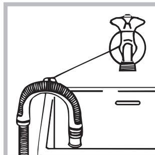
ou bien l'accrocher à un évier ou à une baignoire, dans ce cas, fixer le support en plastique fourni avec l'appareil au robinet (*voir figure*). L'extrémité libre du tuyau d'évacuation ne doit pas être plongée dans l'eau.
