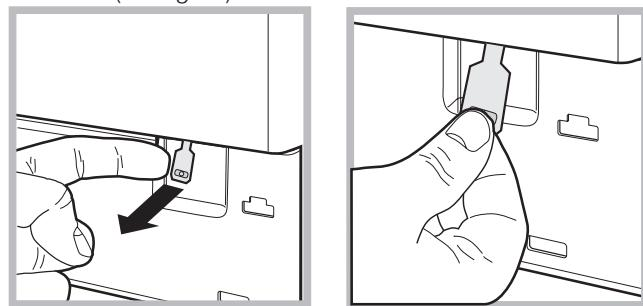
4. se servir de la languette indiquée, tirer vers soi jusqu'à ce que le tirant en plastique se dégage de son cran d'arrêt; tirer ensuite vers le bas et ouvrir l'hublot en même temps.
