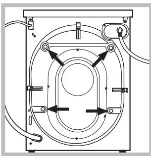
3. Enlever les **4** vis de protection servant au transport, le caoutchouc et la cale, placés dans la partie arrière (*voir figure*).
