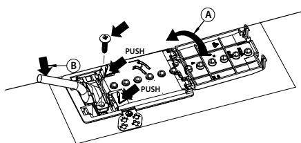
**El aparato debe enchufarse a la alimentación mediante un interruptor seccionador multipolar con un espacio de contacto mínimo de 3 mm.**
