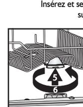
Insérez et serrez à fond les bras d'aspersion supérieur et inférieur.
