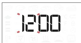
Timernes to cifre begynder at blinke: Drej på justeringsknappen, for at indstille timetallet, og tryk på for at bekræfte.
