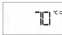
Πιέστε για έναρξη των ρυθμίσεων. Στρέψτε τον επιλογέα για να ρυθμίσετε τον αισθητήρα κρέατος στη στοχευόμενη θερμοκρασία. Πιέστε για επιβεβαίωση. Στρέψτε το κουμπί για να επιλέξετε τη θερμοκρασία φούρνου.
