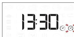
Drej om nødvendigt på knappen, for at indstille tilberedningens ønskede afslutningstidspunkt, og tryk herefter på , for at bekræfte og starte funktionen. Sæt retten i ovnen og luk lågen: Funktionen starter automatisk efter den beregnede periode for at tilberedningen slutter på det tidspunkt, du har indstillet.
