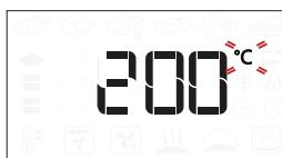
Drej på knappen, når ikonet °C/F blinker på displayet, for at ændre værdien og tryk herefter på , for at bekræfte og (om muligt) fortsætte med at ændre de efterfølgende indstillinger.
