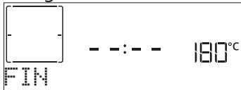
Appuyez sur pour poursuivre la cuisson en mode manuel (sans minuterie) ou appuyez sur pour prolonger le temps de cuisson en réglant une nouvelle durée. Dans les deux cas, les paramètres de cuisson seront conservés.
