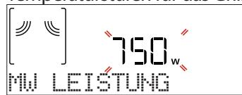
Bitte beachten: Sobald die Funktion aktiviert wurde, kann die Temperatur mit + oder - geändert werden. In Kombination mit anderen Funktionen wird die Mikrowellen-Leistungsstufe auf max. 500 W reduziert.
