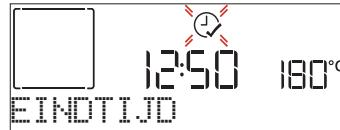
Druk op + of — om het uur in te stellen waarop de bereiding moet klaar zijn, druk vervolgens op ✓ om te bevestigen en de functie in te schakelen. Zet het voedsel in de oven en sluit de deur: De functie start automatisch na een tijdsperiode die berekend is om de bereiding te laten eindigen op het uur dat u gekozen hebt.
