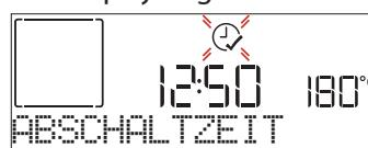
Drücken Sie + oder — zum Einstellen der Zeit für das Ende des Garvorgangs. Drücken Sie ✓ zur Bestätigung und Aktivierung der Funktion. Die Speise in den Ofen stellen und die Tür schließen: Die Funktion startet automatisch nach der berechneten Zeit, damit der Garvorgang zur eingestellten Zeit endet.
