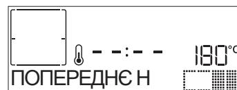
Після завершення цієї фази пролунає сигнал і на дисплей з'явиться повідомлення про те, що духові шафи досягла встановленої температури і до неї потрібно покласти продукти. В цей момент відкрийте дверцята, покладіть продукти до духової шафи, закрійте дверцята і запустіть готування, натиснувши ✓ або ▶.
