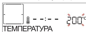
Коли значення блимає на дисплеї, змініть його, натискаючи кнопку + або —, а потім натисніть кнопку для підтвердження. Після цього продовжуйте з наступним налаштуванням (якщо це можливо).
