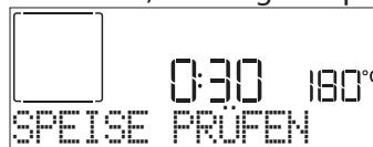
Ein akustisches Signal ertönt und das Display zeigt an, welche Tätigkeit auszuführen ist. Prüfen Sie das Gargut, schließen Sie die Tür und drücken Sie ▶ oder ✓, um den Garvorgang fortzusetzen.
