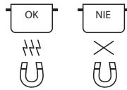
Należy używać wyłącznie garnków i patelni wykonanych z materiałów ferromagnetycznych, odpowiednich do płyt indukcyjnych. Aby określić, czy garnek jest odpowiedni, należy sprawdzić, czy posiada on symbol (zazwyczaj wybitny na spodzie). Do sprawdzenia, czy dany garnek jest ferromagnetyczny, można też użyć magnesu.
