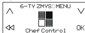
4. Punkty odpowiadające czterem polom grzejnym pojawią się na wyświetlaczu po lewej stronie wraz ze wskazaniem odpowiedniego poziomu mocy (niiski, średni, wysoki).
