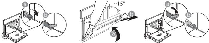
1. Per rimuovere la porta, aprirla completamente e abbassare i fermi fino alla posizione di sblocco.
