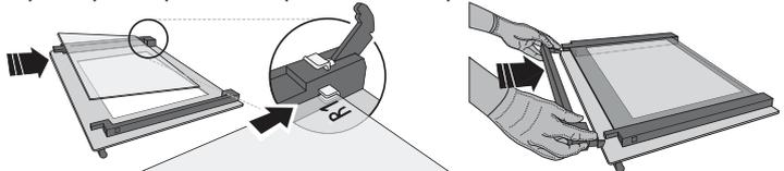
4. Rimontare il profilo superiore: Un clic indicherà il posizionamento corretto. Verificare che la tenuta sia salda prima di rimontare la porta.
