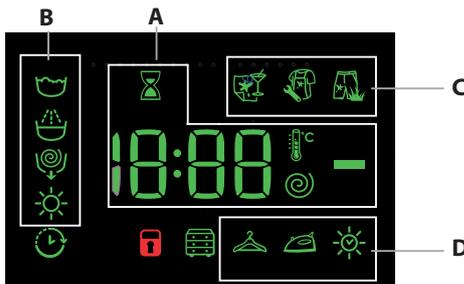
Im Abschnitt **A** werden die Dauer der verschiedenen verfügbaren Programme sowie die Restzeit nach Zyklusstart angezeigt; wurde eine STARTZEITVORWAHL eingestellt, dann wird die bis zum Start des ausgewählten Programms verbleibende Zeit angezeigt.
