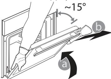
**Réinstallez la porte** en la plaçant devant le four pour aligner les crochets des charnières avec leurs appuis et attacher la partie supérieure sur son appui.
