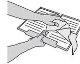
6. Vuelva a introducir el accesorio colocando la parte trasera en las proyecciones que se muestran en la figura, y apriete el asa del accesorio en los cierres superiores.
