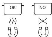
Usare solo pentole e padelle ferromagnetiche adatte ai piani a induzione. Per determinare se una pentola è adatta, controllare se riporta il simbolo (generalmente impresso sul fondo). È possibile avallarsi di una calamita per verificare se le pentole sono rilevabili magneticamente. La qualità e la geometria del fondo della pentola possono far variare le prestazioni di cottura. Alcuni diametri del fondo non corrispondono all'effettivo diametro ferromagnetico.
