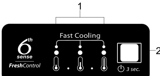
1. LEDs indicadores (apresentam a atual temperatura programada ou a função de Arrefecimento Rápido)
