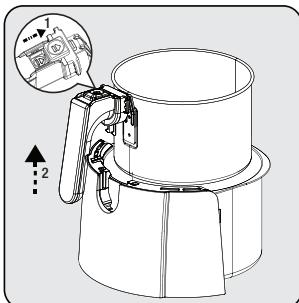
Drücken Sie die Korbentriegelungstaste (3), heben Sie den Griff (4) an, ziehen Sie ihn nach oben und nehmen Sie den herausnehmbaren Garkorb (5) heraus.
