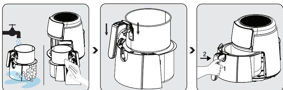
Szufladę koszyka (5) i wyjmowany kosz (6) należy umyć ciepłą wodą z płynem, a następnie osuszyć zewnętrzna powierzchnię urządzenia i umyć części.
