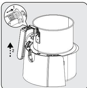
Naciśnij przycisk zwalniający koszyk (3) oraz podnieś i pociągnij uchwyty (4) do góry wyjmując koszyk (5).
