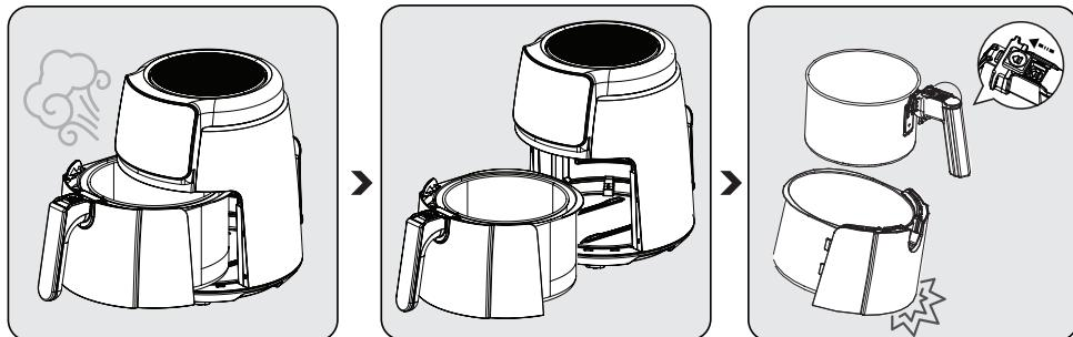
Mientras el aparato está en funcionamiento y cuando se retira la cesta de cocción extraible (5), saldrán gases calientes por la salida de aire (7) y por la parte superior de la cesta. Por lo tanto, preste atención para evitar quemaduras a causa de los gases altamente calientes.
