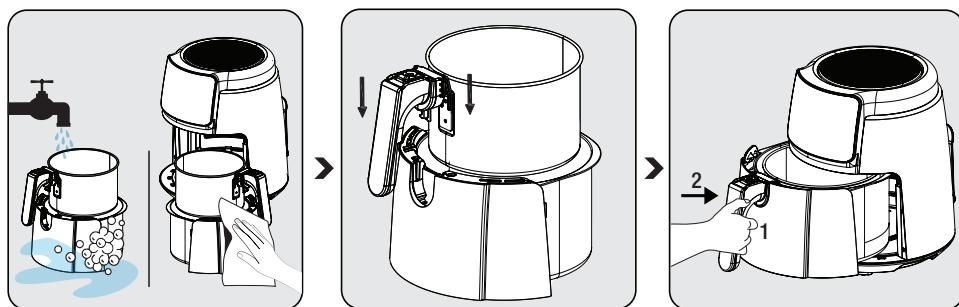
Očistite uklonjivu korpu za kuvanje (6) i fioku korpe (5) topлом vodom sa sapunom, a zatim dobro osušite spoljašnju površinu uređaja i delove koje ste upravo oprali.
