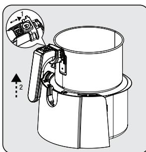
Para liberar la cesta desde el cajón, coloque el cajón en una superficie plana. Desplace la cubierta de protección (2), pulse el botón de liberación de la cesta (3) y eleve la cesta del cajón y extráigala.
