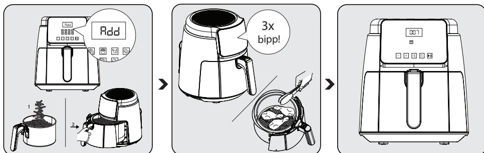
Appuyez sur le symbole pour régler la température et l'heure. Ensuite, appuyez sur le symbole pour régler la température et le temps nécessaires. Appuyez sur le symbole pour démarrer. Lorsque la température réglée est atteinte, l'avertissement "ADD" apparaît sur l'écran. Sortez le panier de cuisson (5) et placez les ingrédients dans le panier, puis remettez-le dans l'appareil.
