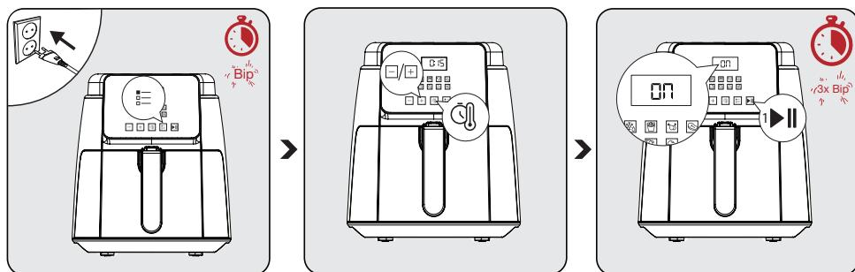
Drücken Sie das Symbol „Start/Stop“, drücken Sie das Symbol „Menü“ so oft, bis Sie das gewünschte Programm gefunden haben, um ein Programm auszuwählen. Wenn das gewünschte Programm gefunden wurde, blinkt die Lampe des Programms, drücken Sie das Symbol „Start“, um das Programm zu starten.
