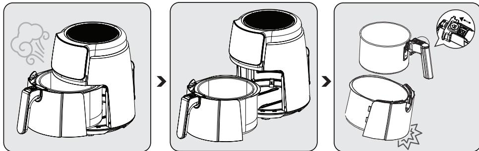
În timp ce aparatul funcționează și când coșul de gătit dețasabil (5) este tras înapoi, gazele fierbinți vor fi emise din orificiul de evacuare a aerului (7) și din partea superioară a coșului. Prin urmare, aveți grijă să evitați arsurile produse de gazele foarte fierbinți.
