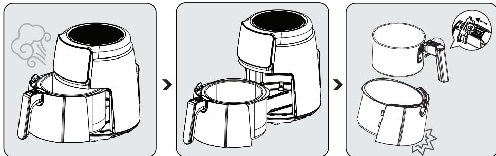
Dok aparat radi i kada se uklonjava korpa za kuvanje (5) povuče unazad, iz njenog izlaza za vazduh (7) i gornjeg dela korpe izlaziće vrući gasovi. Tako pazite da izbegnete opekotine koje nastaju usled jako vrućih gasova.
