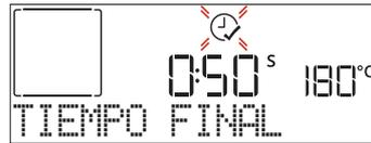
Pulse + o - para configurar la hora a la que quiere que termine la cocción y pulse
