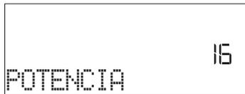
Pulse + o – para seleccionar 16 «Alto» o 13 «Bajo» y pulse ✓ para confirmar.
