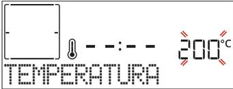
Cuando el valor parpadee en la pantalla, pulse + o - para cambiarlo, después pulse
