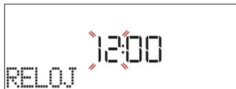
Pulse + o – para establecer la hora actual y pulse ✓ : En la pantalla parpadean las dos cifras de los minutos. Pulse + o – para ajustar los minutos y pulse ✓ para confirmar.
