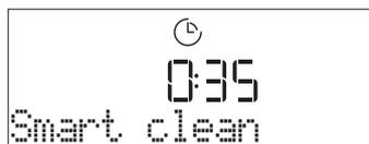
Pulse para activar la función: la pantalla le indicará que realice todas las acciones necesarias para obtener los mejores resultados de limpieza: Siga las indicaciones y después pulse cuando haya acabado. Una vez realizados todos los pasos, cuando sea necesario pulse para activar el ciclo de limpieza.
