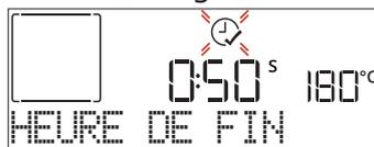
Appuyez sur **+** ou **-** pour régler l'heure à laquelle vous souhaitez que la cuisson se termine, puis appuyez sur **✓** pour confirmer et activer la fonction. Placez les aliments dans le four et fermer la porte : La fonction démarre automatique après une période de temps déterminée pour que la cuisson se termine au moment désiré.
