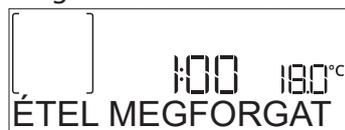
Hangjelzés hallatszik, és a kijelzőn látható a szükséges művelet. Nyissa ki az ajtót, hajtsa végre a kijelzőn látható műveletet, majd csukja be az ajtót, és nyomja meg a gombot a sütés folytatásához.
