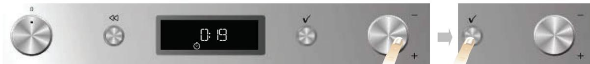
Cette fonction ne peut être utilisée que lorsque le four est éteint et est utile, par exemple, pour contrôler le temps de cuisson des pâtes. La durée maximum pouvant être réglée est de 23 heures et 59 minutes.
