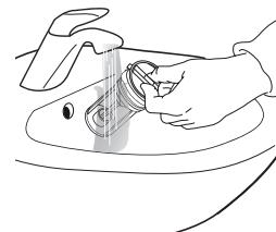
6. Umetnute filter za vodu i ponovno postavite postolje: vratite na mjesto filter za vodu okretanjem u smjeru kazaljke na satu. Pobrinite se da ga navijete dokle ide; drška filtra mora biti u vertikalnom položaju. Kako biste provjerili vodonepropusnost filtra za vodu, ulijte oko 1 litru vode u dozator za deterdžent. Zatim ponovno postavite postolje.
