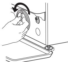
4. Uklonite filter: ispod filtra za vodu položite pamučnu krpku koja će upiti malu količinu preostale vode. Zatim izvadite filter za vodu okretanjem suprotno od smjera kazaljke na satu.
