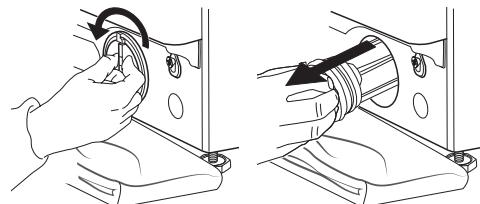
5. Očistite filter za vodu: uklonite ostatke u filtru i operite ga tekućom vodom.
