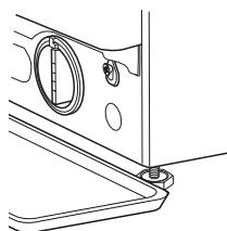
3. Ispustite vodu: polako okrećite filter suprotno od smjera kazaljke na satu dok sva voda ne isteče. Pustite da voda isteče, ali nemojte ukloniti filter. Kada se spremnik napuni, zatvorite filter za vodu okretanjem u smjeru kazaljke na satu. Ispraznite posudu. Ponavljajte postupak sve dok ne isteće sva voda.
