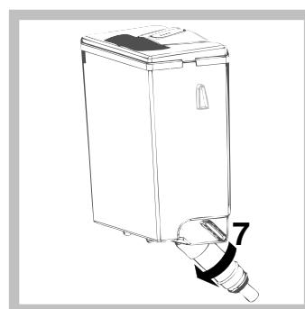
Po završetku čišćenja ventil ponovno zavijte pazeći da unutarnja brtva prianja na krajnji dio ležaja spremnika; zatim vratite sklop spremnika na odgovarajuće cilindrično kućište vrata pazeći da je gornja kukica na stražnjoj stjenki spremnika pravilno umetnuta u odgovarajući dio na stražnjoj stjenki vrata. Vratite prethodno skinute rubove i pokrov spremnika na mjesto.
